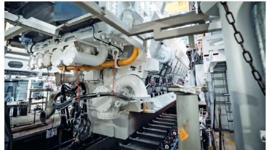
Vier Caterpillar MaK Dual Fuel-Motoren der Baureihe M46 DF sind auf der „AIDAnova“, dem ersten Kreuzfahrtschiff mit einem reinen LNG-Antrieb, installiert
